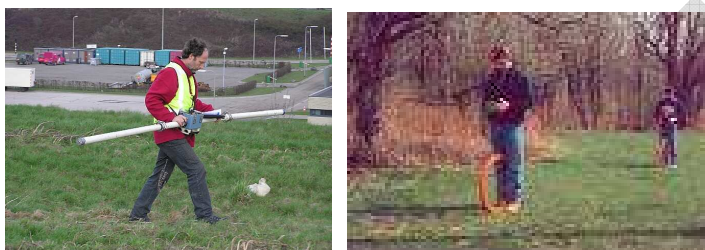
Figuur 3.1. Uitvoering EM31 en EM34 metingen.
