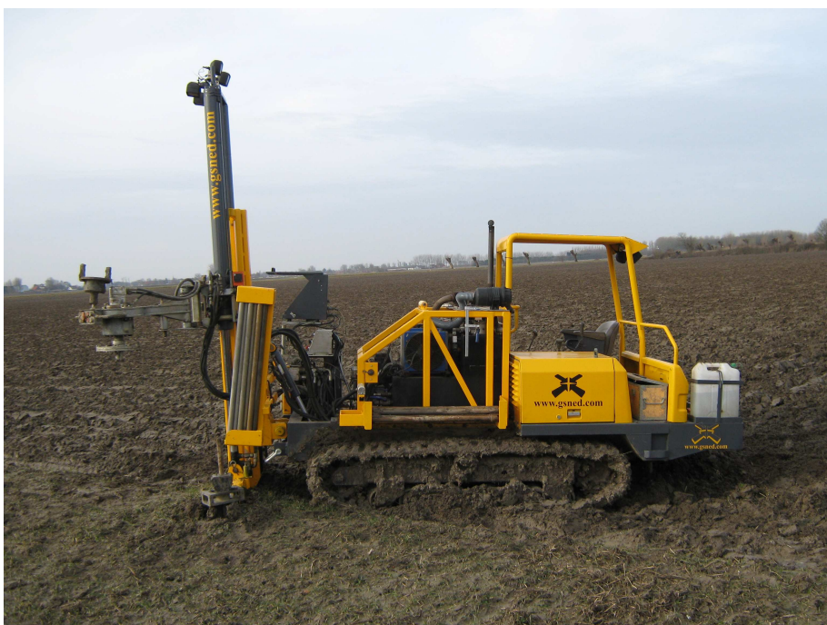
Figuur 3.4. EC-sondering. Foto: Bouw- en Management Service b.v.
