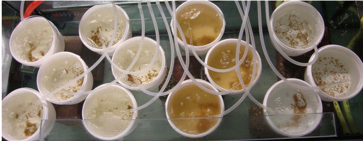
Figuur 5.1 Opstelling groeiproef tapijtschelpenbroed. Van links naar rechts: triplo -22mV, triplo -22mNV, triplo -45mV (de donkere kleur in deze behandelingen komt door niet gefiltreerde algen door het tapijtschelpenbroed) en triplo Oosterscheldewater als blanco.
