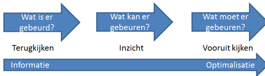
Figuur 5: Van sluismonitoring naar optimalisatie van beschikbaarheid en betrouwbaarheid door gebruik van data en (van links naar rechts in de figuur) steeds meer geavanceerde analyse- en predictie methoden. Een basis voor ‘predictive maintenance’.
