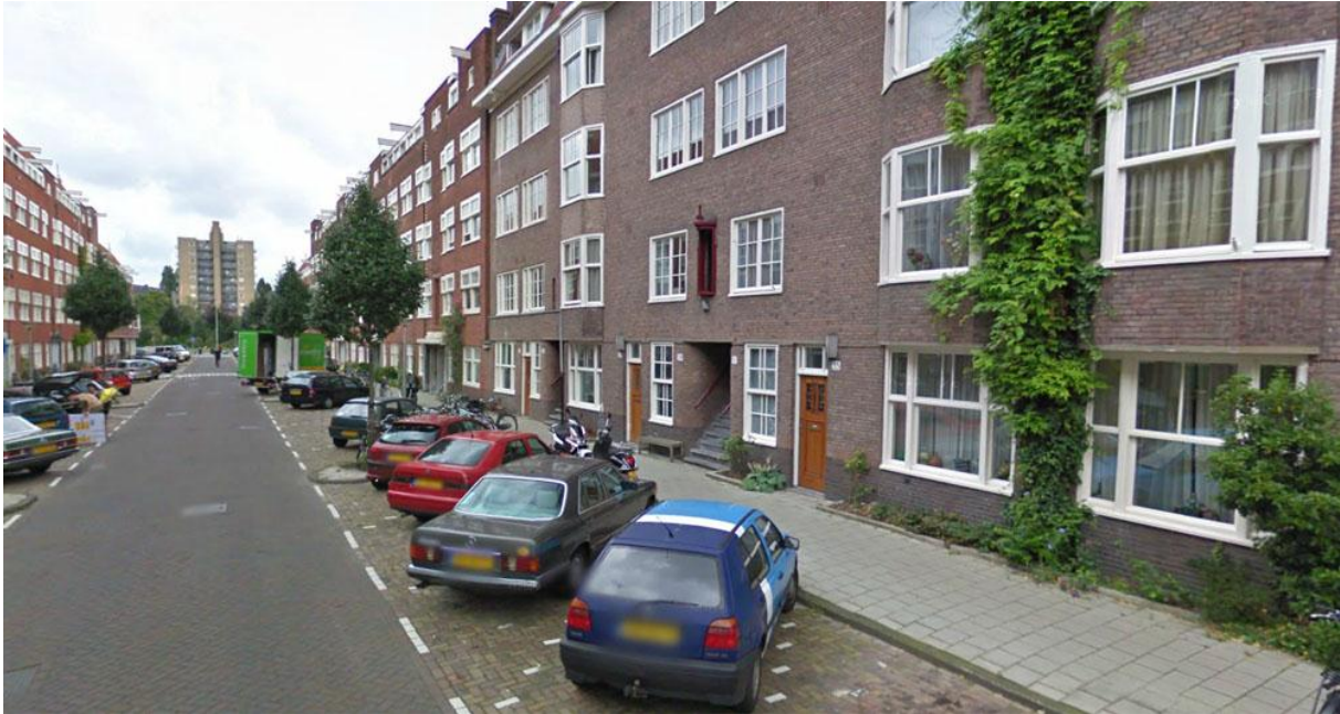
Gordel '20 – '40: Biesboschstraat: gebakken klinkers in de rijweg, hergebruikte klinkers in het parkeervak, 30x30cm tegels in het trottoir.
