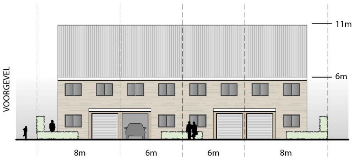
afbeelding: aanzicht noordgevel bouwmassa schaal 1:200
