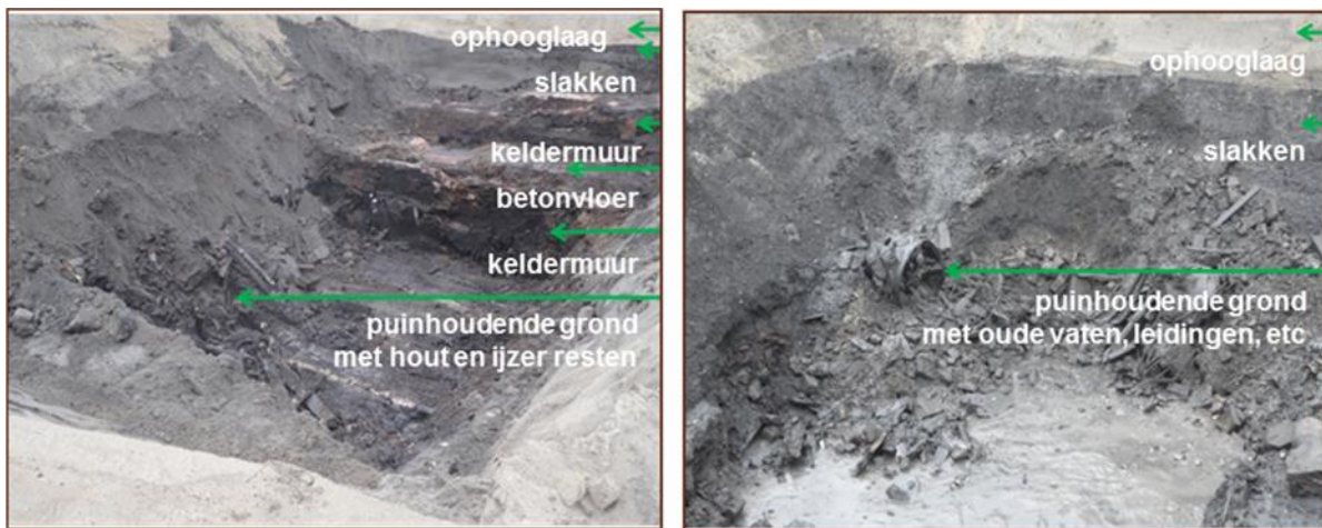
Figuur 3.5: Sleuf in deelgebied 3 (links) en sleuf in deelgebied 2 (rechts)
