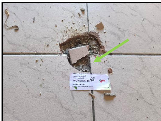
M48 – tegellijm is niet asbesthoudend.
