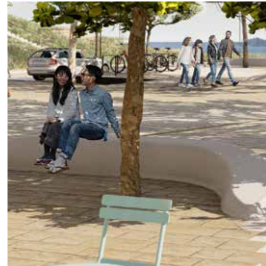
zitelementen duinplein en strand; monolitisch afgewerkt spuitbeton; zie details; zithoogte 45cm, breedte 70cm betonsamenstelling in bestek (lev. Mebin o.g.), kleurpigmentering "crème" volgens bemonstering ZUS; leverancier: SkateOn o.g.
