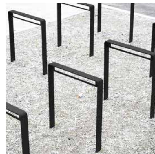
fietsnietjes Duinplein, stalen fietsbeugel; maatwerk, stalen strip, gezet, 6mm dik, 80mm breed met dwarsstrip, 6mm dik, 40mm breed; geheel verzinkt en gecoat RAL 9004 afm. (hxl) 900x1600mm (900mm boven maaiveld); leverancier: Boeg B.V. o.g.; zie details aantal stallingsplekken op basis van kencijfers crow (horeca) en woonkeur (woongebouw)
