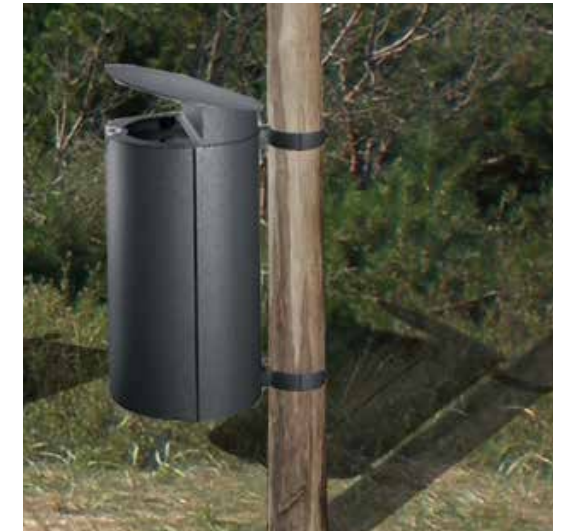
prullenbak, type: Carpo, afm. 57x745cm, inhoud:90 liter, materiaal: verzinkt en gecoat staal, kleur: RAL7021 Montage: n.t.b. aan paal; Leverancier: Hess o.g.
