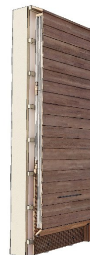
Figuur 18 Ook bij moderne gevels kunnen royale vleermuisvoorzieningen worden aangebracht. Rechts een vergroting van de vleermuisvoorziening in de gevelbetimmering.
