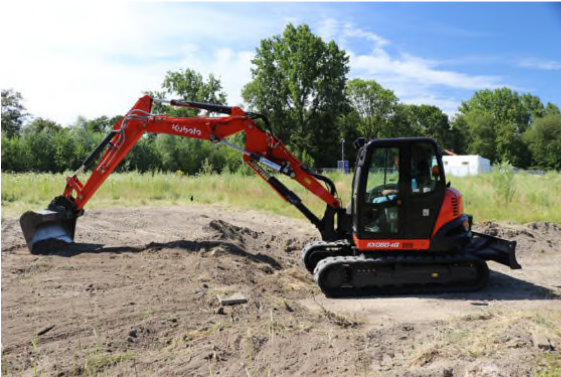
Figuur 1 - Voorbeeld van een rupskraan van ca. 8 ton met een driedelige giek
