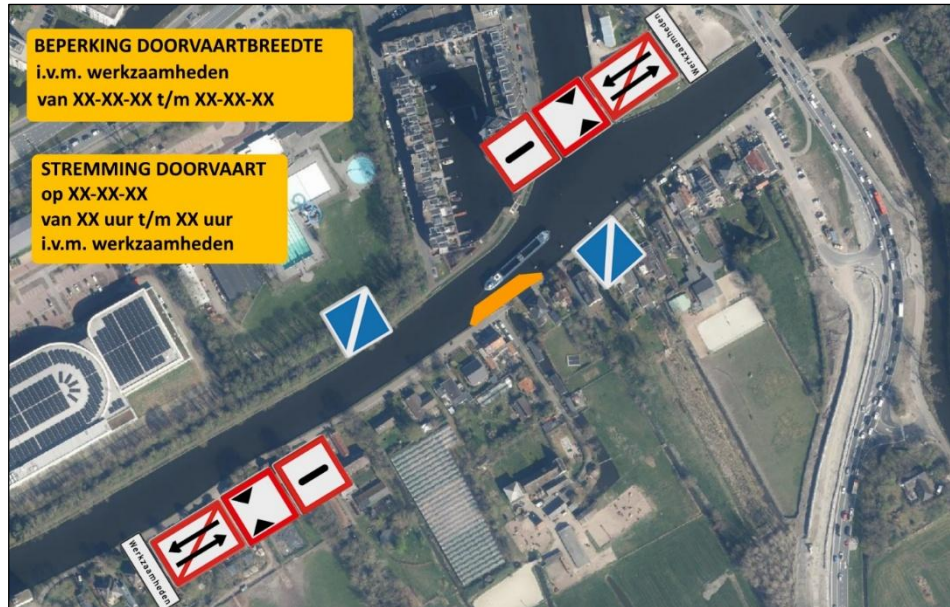
Figuur 6. Bebordingsplan tijdens werkzaamheden brug 151
