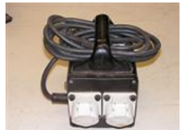
trafo buiten de ruimte plaatsen!
