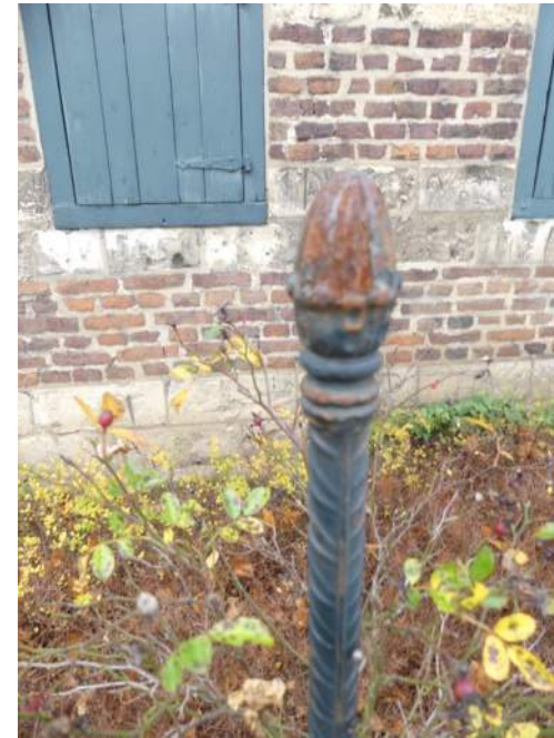
Afb. §46.21, roestvorming op gietijzeren tuinpaal
