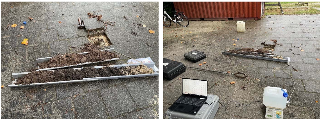
Figuur 8: Bodemprofiel infiltratieboring en meetopstelling.
