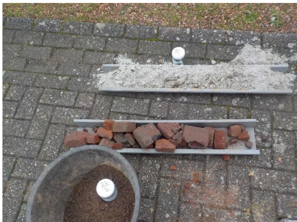
Foto 9. Uitgegraven fundatiemateriaal proefgat 22
