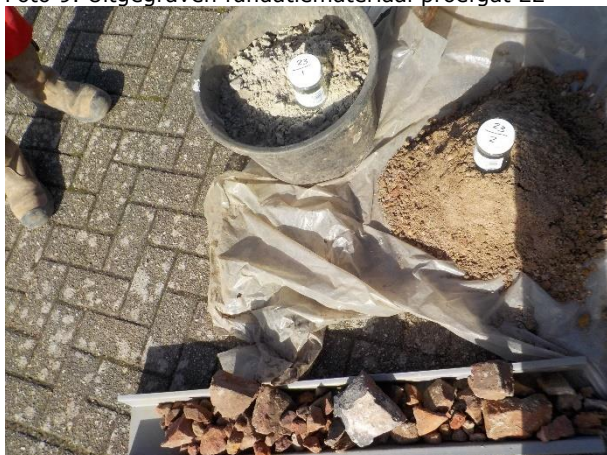
Foto 11. Uitgegraven fundatiemateriaal proefgat 23
