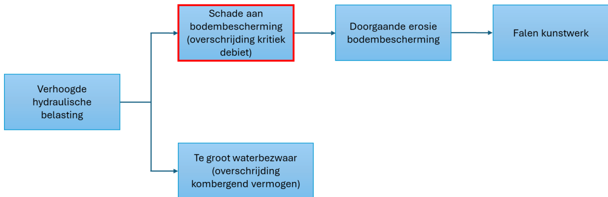
Figuur 6: Faalpad hoogte (langsconstructies)
