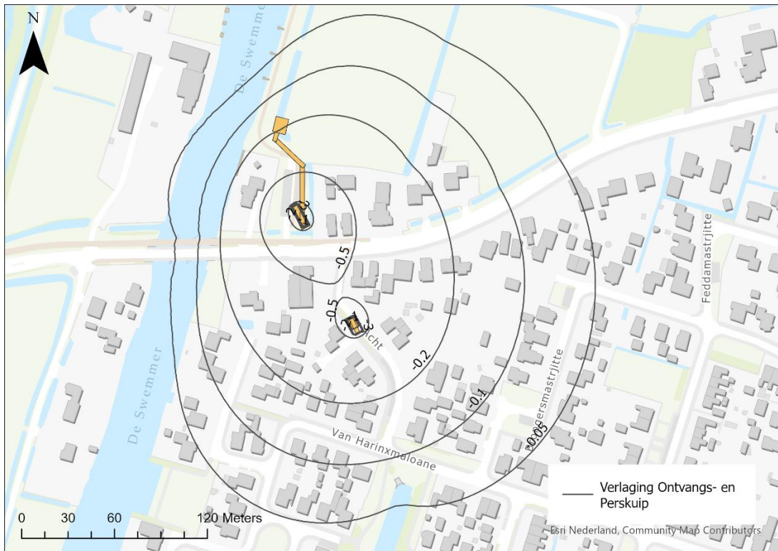
Figuur 4-2 - Verlagingen in de omgeving (freatisch) voor fase 2 ontvangst- en perskuip
