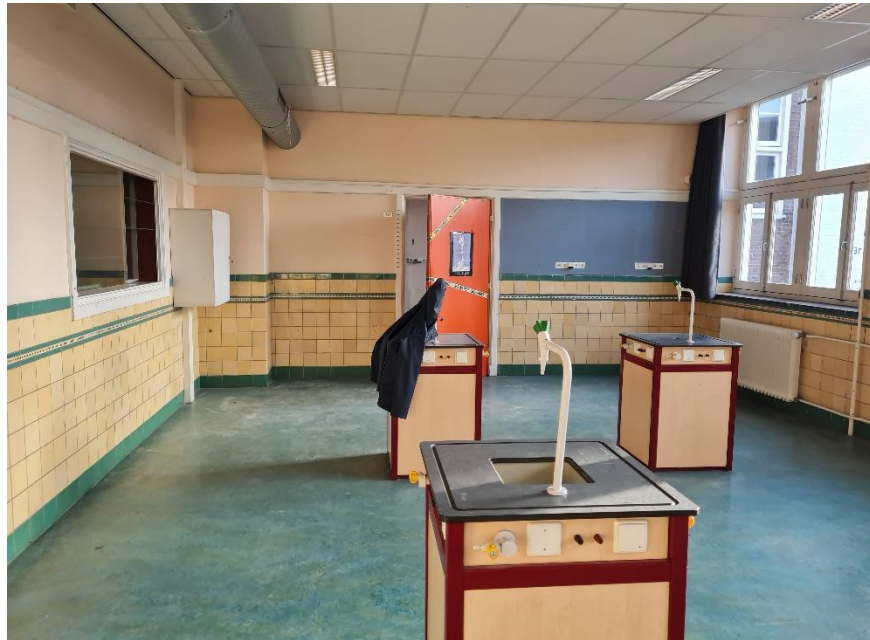
Scheikunde lokaal aan de zijde van het plein. De praktijktafels zijn van latere datum. De lambriserings, lijsten langs de wanden raam en deuren dateren nog uit de bouwtijd (naar de kleine ruimte heeft een opdekplaat). Achter het systeemplafond bevindt zich de oorspronkelijke afwerking (gestucte plafonds met lijstwerk, met eveneens gestucte balken).
