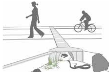
Faunatunnel als faunapassage
