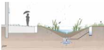
O.1. Wadi (waterafvoer door infiltratie)
