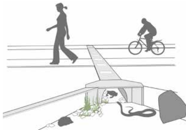
Faunatunnel als faunapassage.
