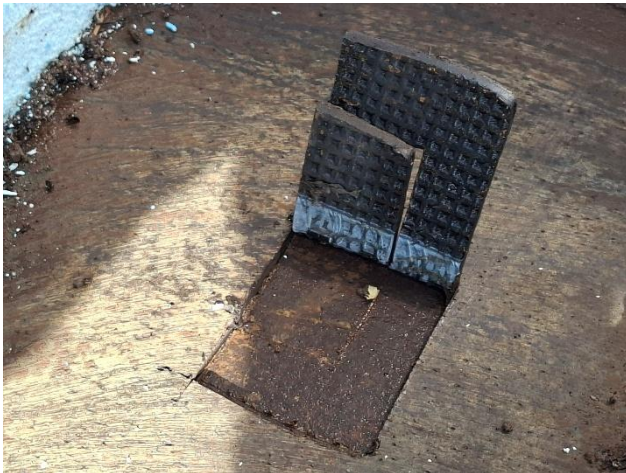
Foto 7 Bij de tweede insnijding is een redelijke verkleefing aanwezig.
