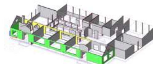
Overzicht versterkte wanden Grijs: versterkt met houten ribben Geel en groen: versterkt met jacketing (opdikken met koolstof mesh) en houten ribben.
