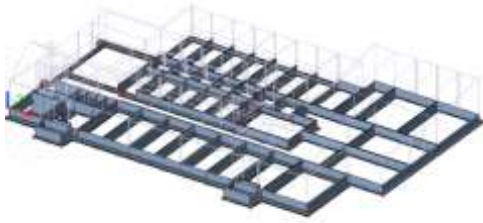
Overzicht modellering fundering – bestaande situatie
