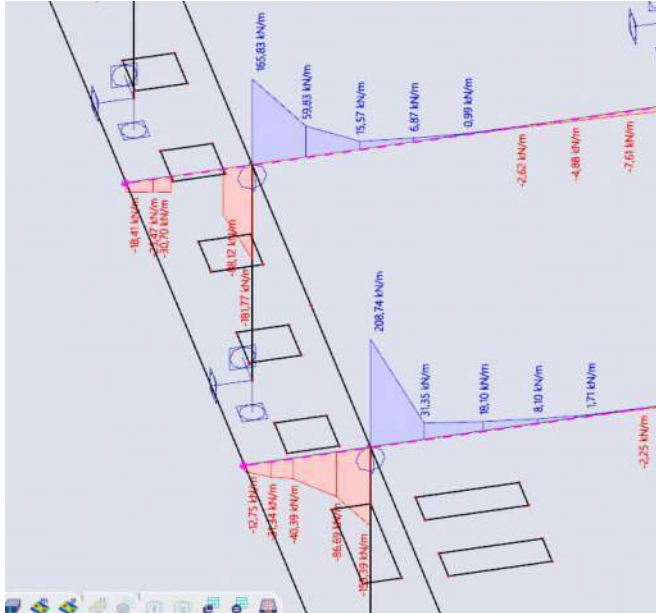
Figuur 7: HVI module Vx ter plaatse van middelste twee sparingen
