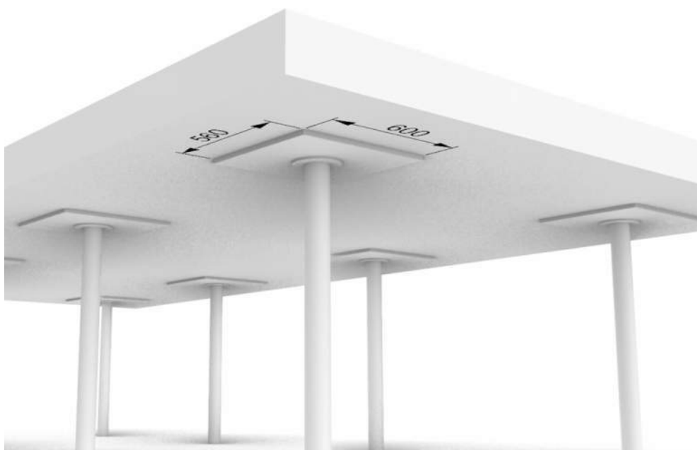
Figuur 4: Krachtsverdeler tussen paalkop en CLT-vloer, principeschets
