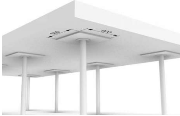
Figuur 4: Krachtverdeler tussen paalkop en CLT-vloer, prinsipschets
