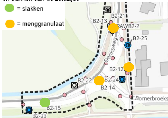
Afbeelding 11: Locatie fundatiepakket van menggranulaat en slakken aan de zuidzijde
