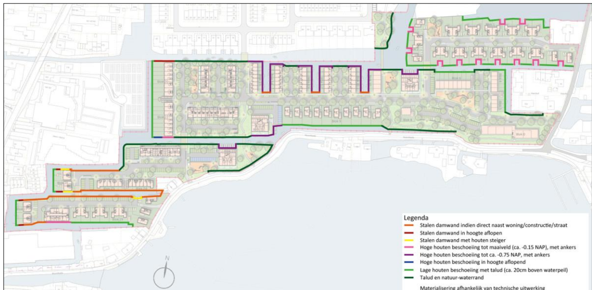
Figuur 3-1: Bovenanzicht toekomstige en bestaande watergangen met type grondkering [8]
