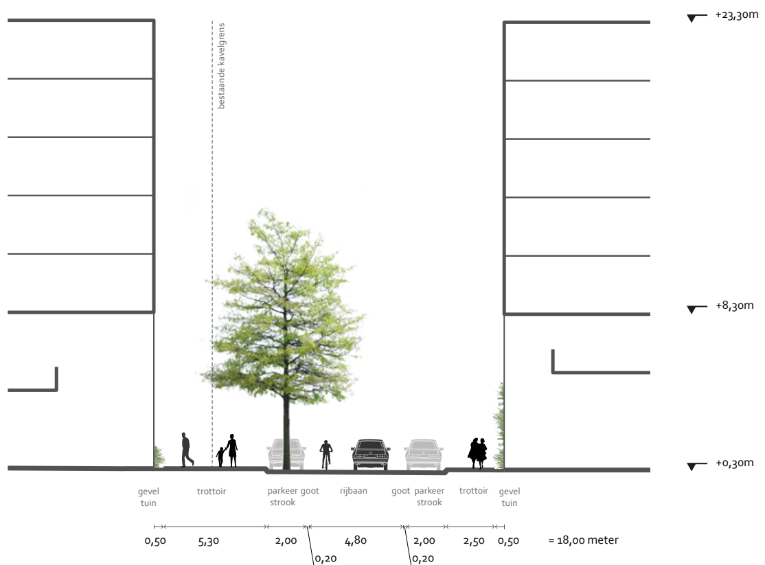
Doorsnede, nieuw profiel Wenckebachweg Oost I
