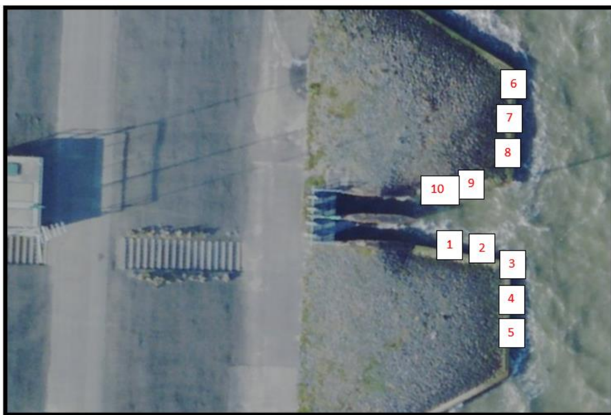
Figuur 38: Meetlocaties staaldikte damwand uitstroom.
