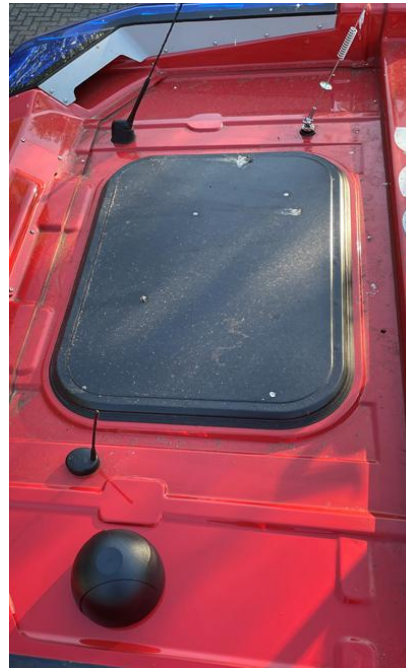
Voorbeeld dak opstelling antennes
