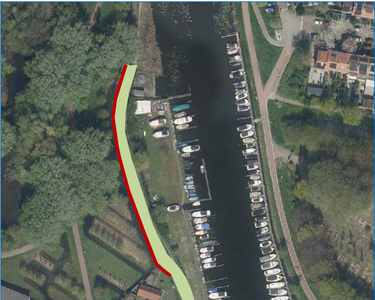
122_2b deeltraject F: voorkeursvariant kering in grond met stabiliteitsscherm
