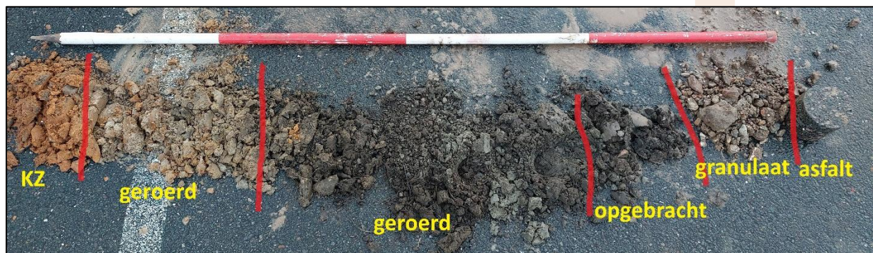
Afbeelding 16. Voorbeeld van een verstoorde boring. In dit geval de boorkern van boring 4 (KZ= keizand)
