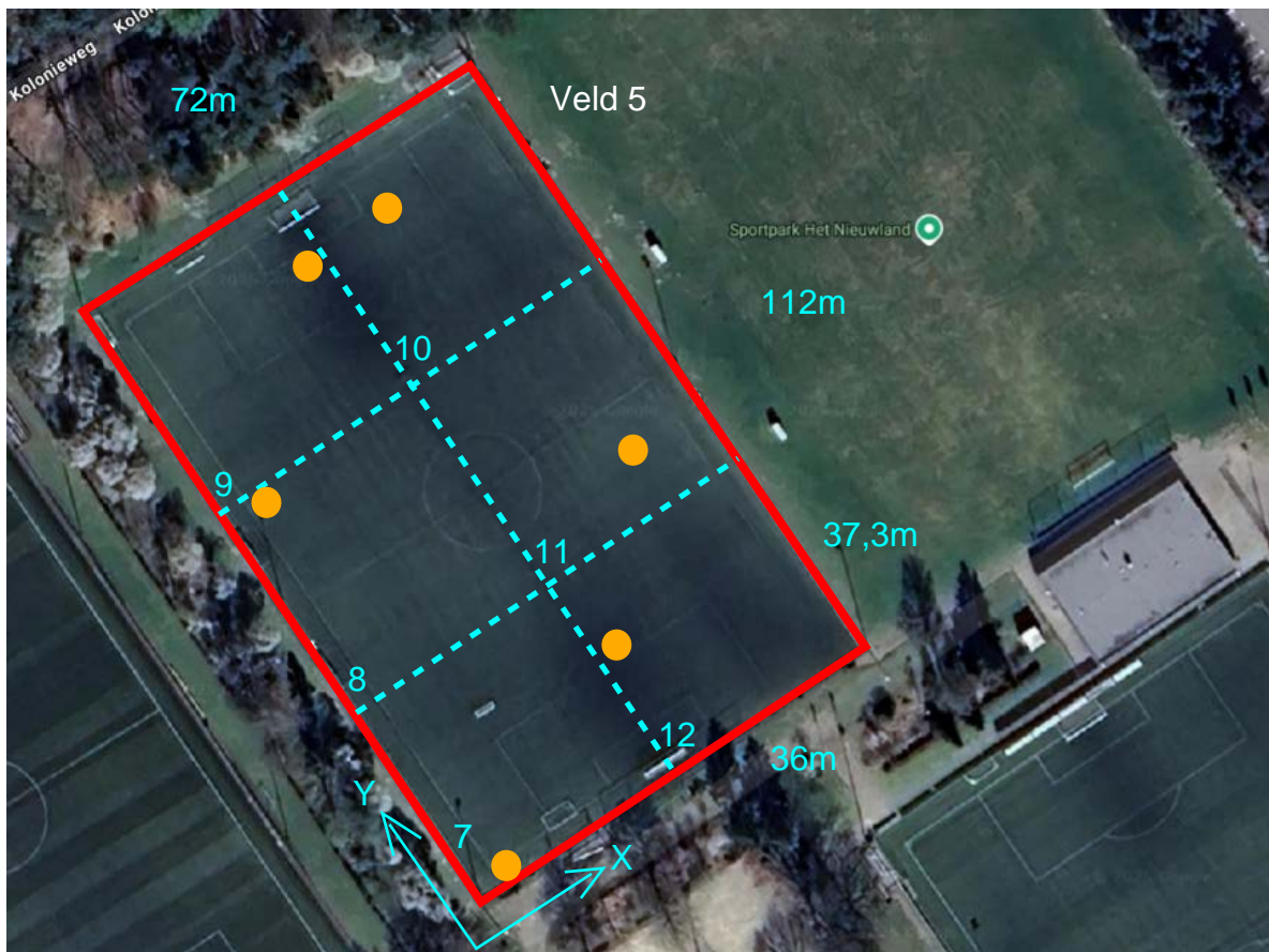
Veld 5, sporttechnische laag van menggranulaat / gezeefd betongranulaat E-bodemas Beide velden apart van elkaar bemonsteren ivm andere sporttechnische laag
