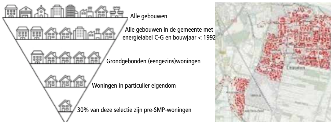
Afb. 2 en 3 Berekening van percentage pre-SMP-gebouwen ten opzichte van het totaal en de visuele weergave in de GIS-applicatie voor de kern Leusden
