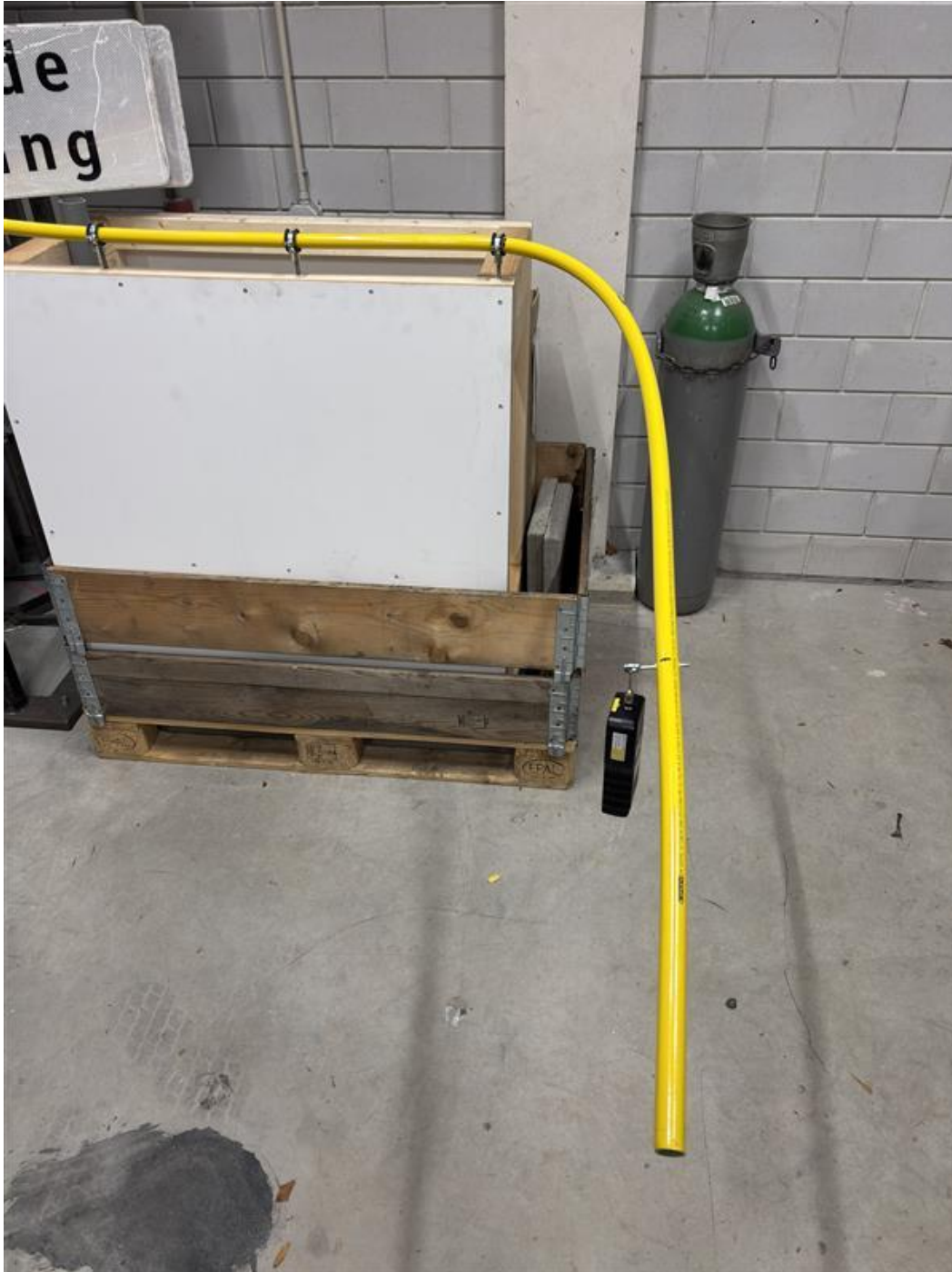
Afbeelding 2: gesimuleerde praktijksituatie waarbij de meerlagenbuis wordt gebogen en de benodigde buigkracht wordt gemeten middels een zogenaamde 'dynamometer'. Bij deze test zal beoordeeld worden of de buis voldoende en in welke mate buigbaar is.
