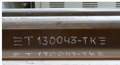
figuur 2: markering van oplassing indien us-nummer aanwezig
