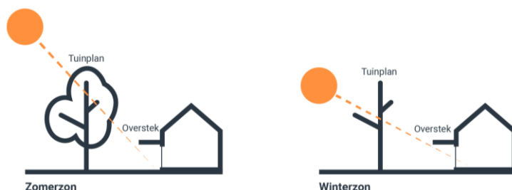
Figuur 2 Overstek principe winter- en zomerzon ( https://www.handelbouwadvis.nl/voorkom-oververhitting-passieve-koeling/ )
