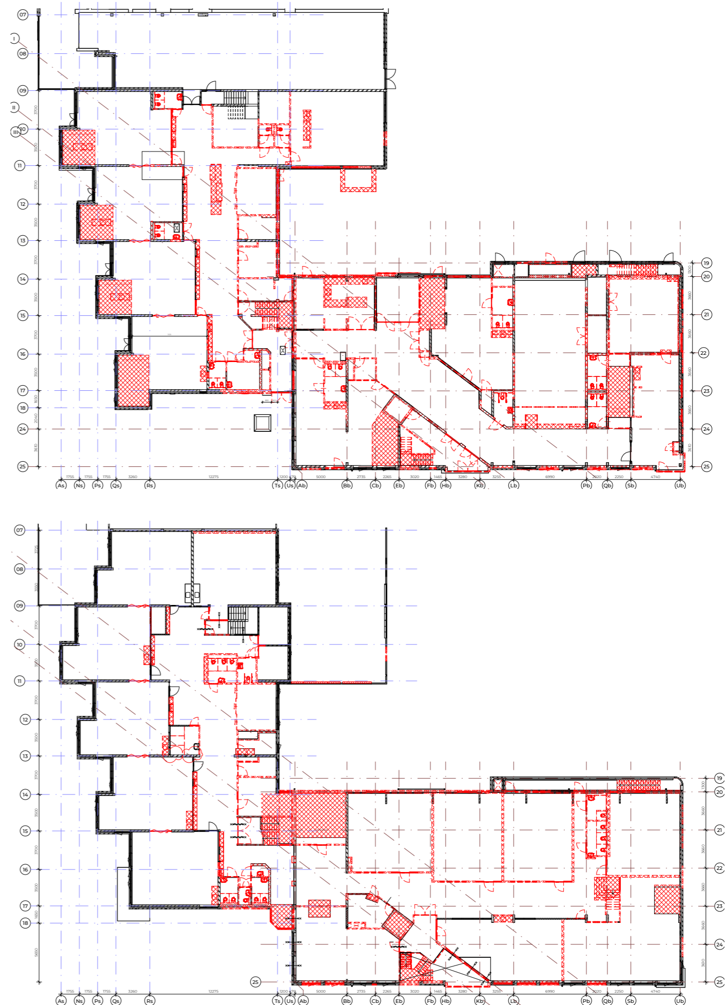
Afbeeldingen boven: Plattegronden huidige toestand met in rood aangegeven de te verwijderen delen t.b.v. de nieuwe structuur en ruimtelijke indeling
