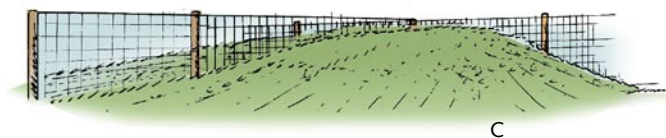
Fig. 7.35 Voorbeeld van een inspringvoorziening
