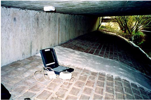
Sporenbed (zand) en faunadetector met chip voor registratie van passages. Met de laptop worden de gegevens uitgelezen en opgeslagen
