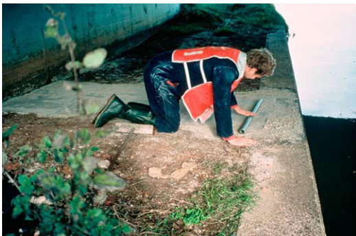
Het sporenbed van zilverzand wordt gladgerold met een pvc-buis
