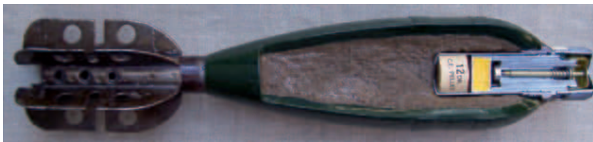
Afb. 6.12 Doorsnede door een 3-inch mortiergranaat, met rechts de ontsteker. 112
