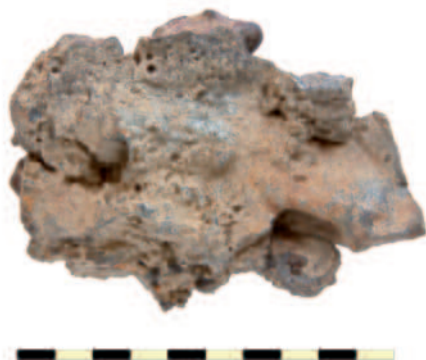
Afb. 6.21 De naar het vuur gewende en partieel verglaasde zijde van ovenwandfragment (vnr. 2-2). De schaalverdeling is in cm.
