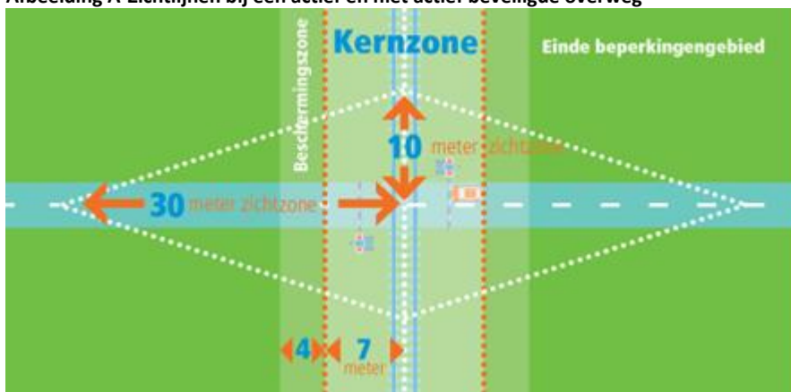
Afbeelding A Zichtlijnen bij een actief en niet actief beveiligde overweg
