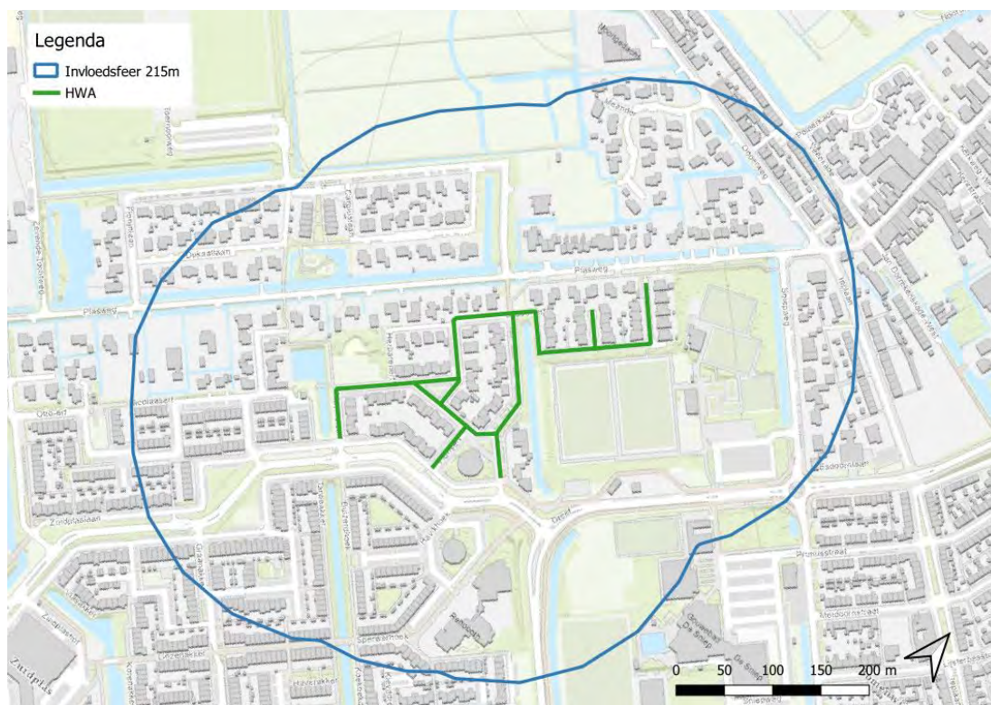
Figuur 6.1: Invloedsfeer bemaling (invloed is berekend op maximaal 215 m na 7 dagen bemaling)
