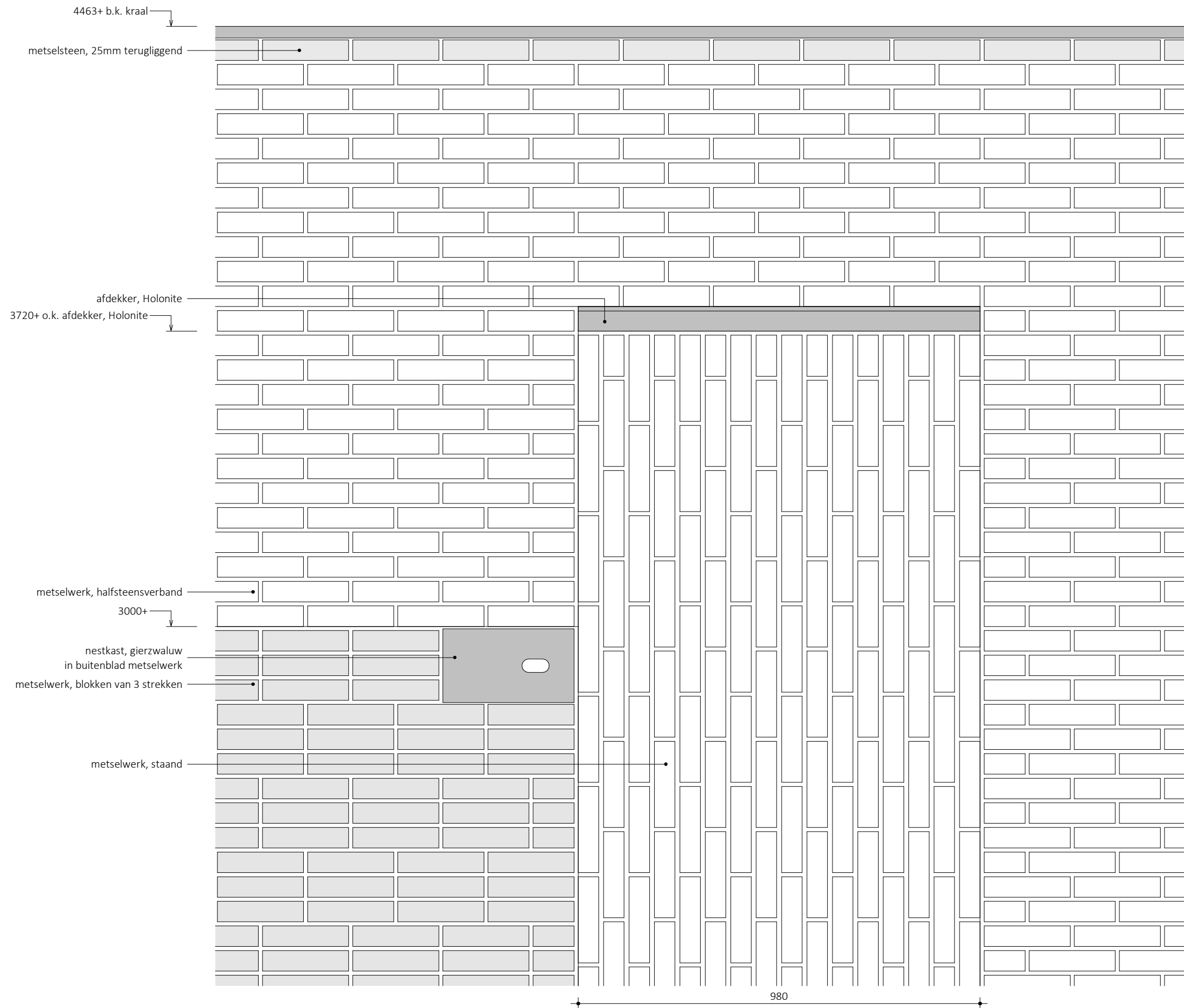
gevel detail metselwerk
