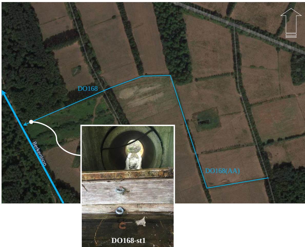
Figuur 14 Situering stuw DO168-st1 in de watergang DO168(AA) na het bijplaatsen van 2 schotjes (+ 30 cm). Aan het eind van de duiker is de uitmonding in de Berkenloop zichtbaar.
