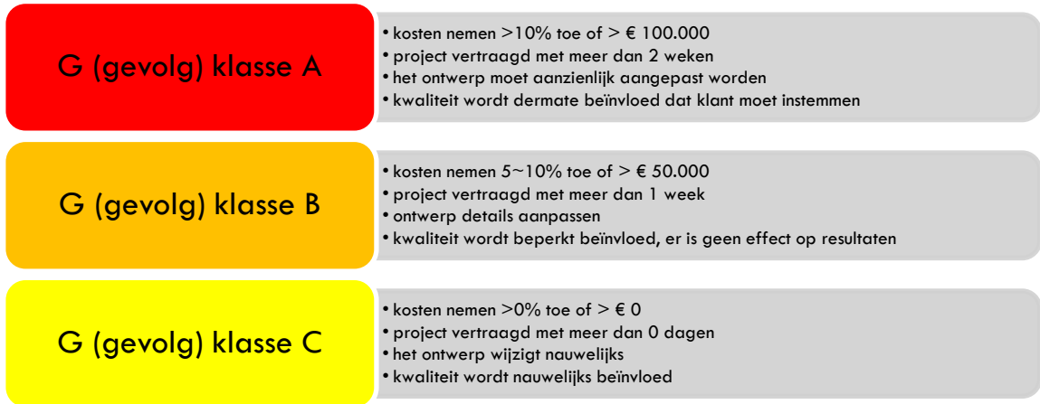
Figuur 11 –klasse A tot en met C, de gevolgen zijn rechts van de klasse beschreven in het grijze vlak. Het kan zijn dat een of meerdere gevolgen van toepassing zijn.
