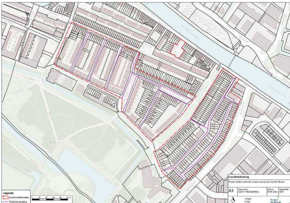
Figuur 1: Onderzoekslocatie en te vervangen riooltracé
