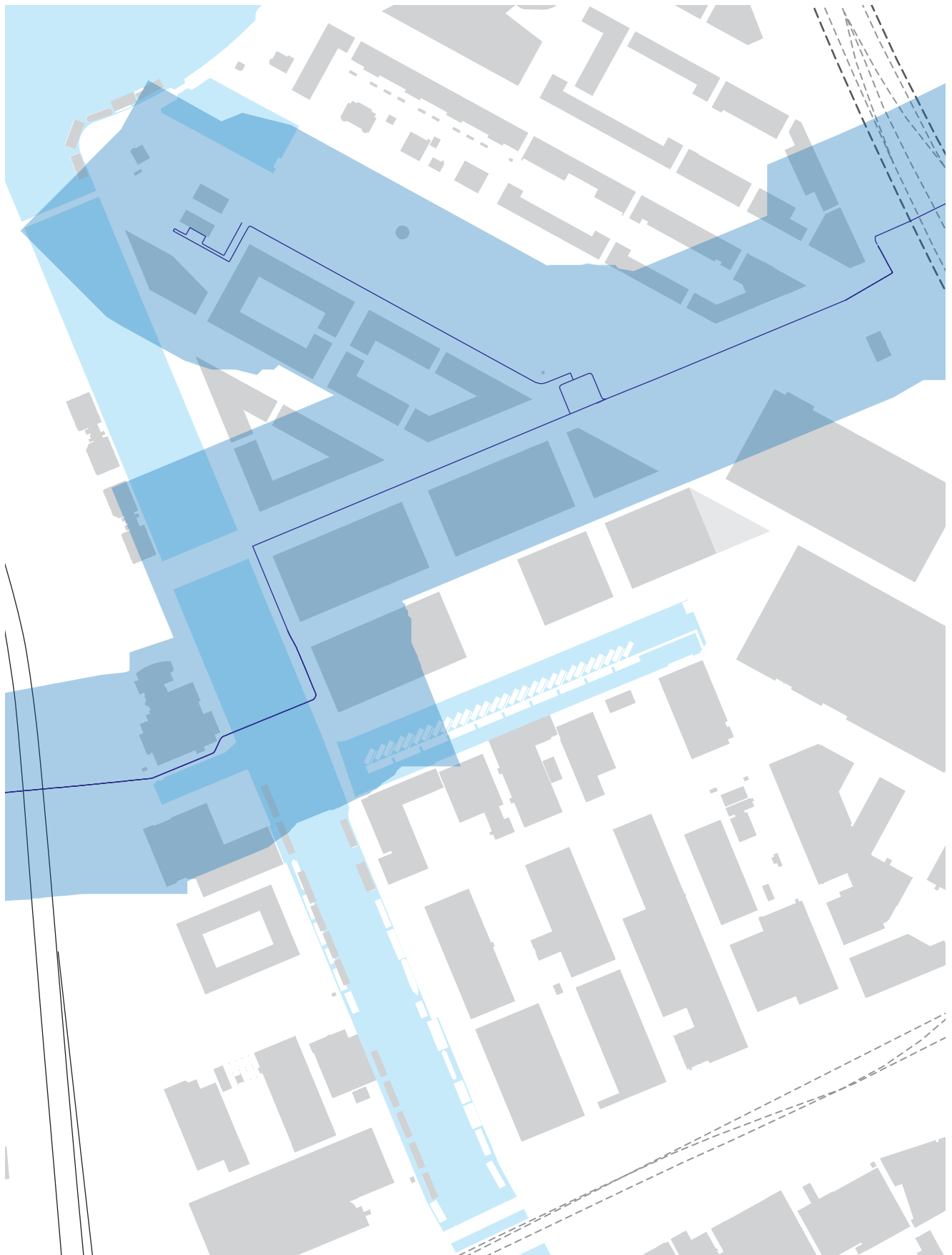
Figuur 4: Belemmeringszone door bestaande gasleiding
