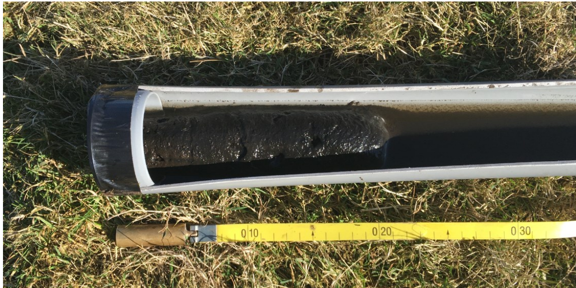
Afbeelding 4.2 Impressie van een waterbodemonster die is opgevangen in de opvangbuis. De bovenste 5 cm dient te worden bemonsterd
