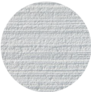
BRUGDEK Beton Gebezemd
