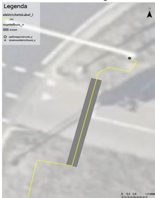
Afbeelding 1: actuele situatie – een OVL-kabel loopt via een mantelbuis naar een straatmeubilairLichtpunt_p object (OVL-verlichting)
