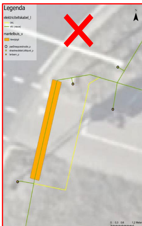
Afbeelding 1: actuele situatie – een OVL-kabel loopt via een mantelbuis naar een straatmeubilairLichtpunt_p object (OVL-verlichting)
