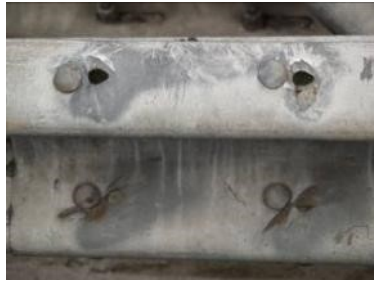
Afbeelding 24 Ernstige haken en slijpsporen
