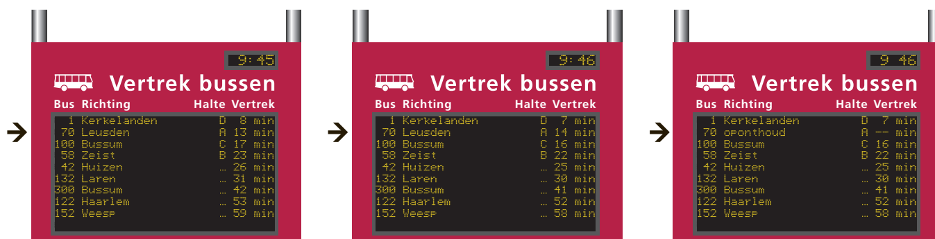
Afbeelding 10 Opeenvolgende schermen (van links naar rechts) waarbij bus 70 Leusden oponthoud heeft; De positie van de richting alterneert met tekst 'oponthoud' en het aantal minuten '14' alterneert met de <-->. De volgorde volgens t.t.v. wordt eventueel aangepast (de betreffende rit zakt dan verder naar beneden in de lijst).
